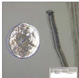
Vor Ätzung: Zinnrückstand Ø 180 µm auf Luftseite
