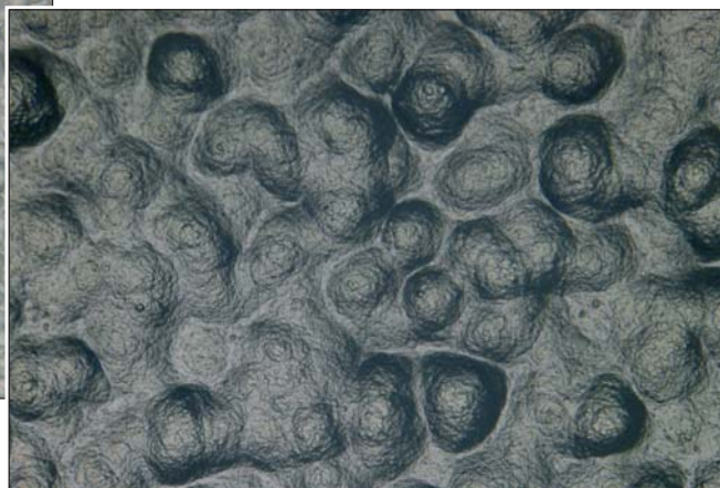
Flusssäure verändert die Glasoberflächen: Je nach den gewünschten Eigenschaften variieren Rauheit und Tiefe der Struktur. Zu sehen sind die verschiedenen Ergebnisse nur unter dem Mikroskop.
