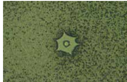
Beschichtungsfehler durch Zinntropfen
